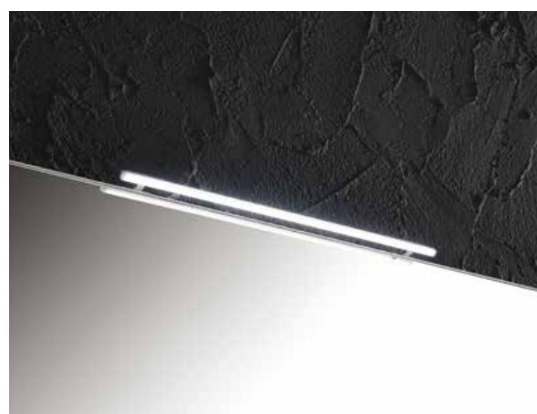
FA331 bis FA332 LED-Leuchte EDISON, (Polycarbonat). Abmessungen: 51x4,5x1,5H cm LED 6 Watt Inkl. Trafo 24V 6000 °K / 594 Lumen IP44
